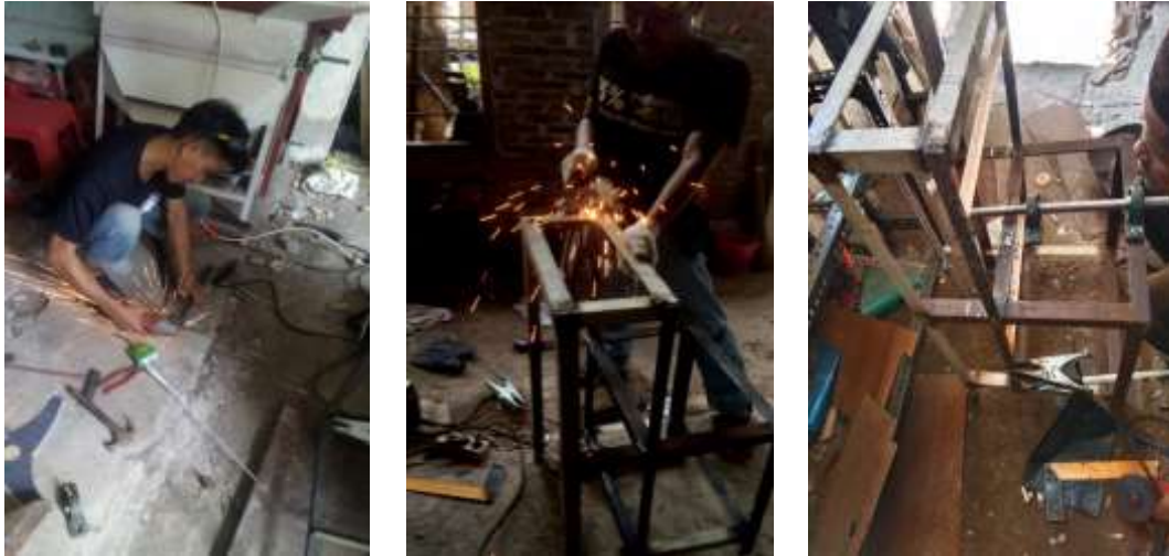
Gambar 4 Proses Pembuatan rangka alat pemipil jagung
