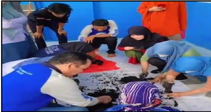
Gambar 10 : cetak adonan dengan memasukkannya dalam cetakan secara padat, lalu keluarkan dari cetakan
